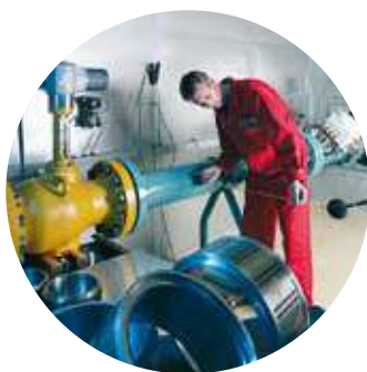
Стенд высокого давления Уникальный стенд служит для замера уровня шума при проверке новых технических решений
