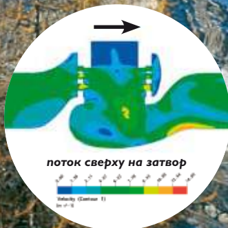
Обычный седельный клапан Турбулентность и высокие скорости на выходе повышают риск отказов в работе, связанных с ростом уровня вибрации.
